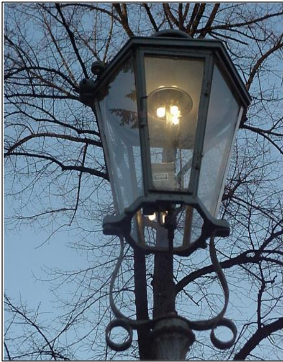
Bild 1: Originale Gaslaterne mit Gasbeleuchtung und 3 leuchtenden Glühstrümpfen
